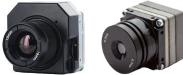
Şekil 7. Soğutmasız sistemli Flir Tau 2 640 (solda) ve Flir Quark 2 (sağda) modelleri
