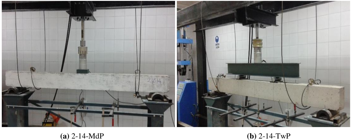
Şekil 3. Teste tabi tutulan kirişlerin yük uygulanmadan önceki görüntüsü
