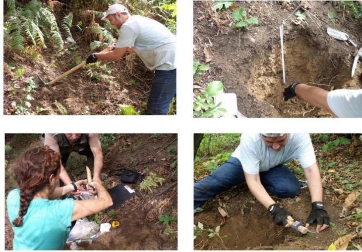
Şekil 2.3 : Deneme alanlarında açılan çukurlarda 4 farklı derinlik kademesinden yapısı bozulmuş ve yapısı bozulmamış toprak örneklerinin alınması.
