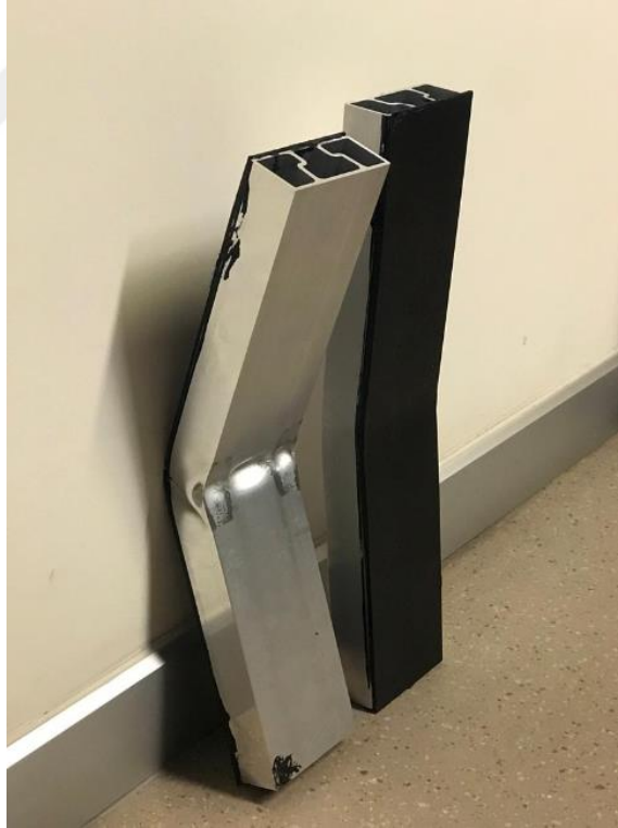
Şekil 5.5 : Kompozitli Ters ve Düz numunelerin deformasyon şekli.
