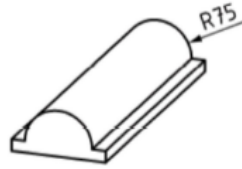
Şekil 2.2 : Batarya taşıyıcısına uygulanacak yükün çenesi.
