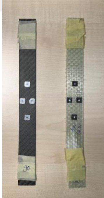
Şekil 2.14 : ASTM D3039 göre 90° yönünde hazırlanan numuneler.
