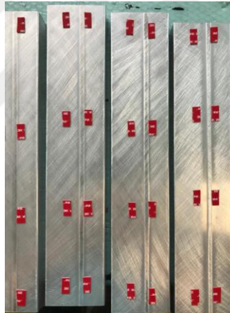
Şekil 2.27 : Yapıştırıcının yüzeyde kalması için yükselti oluşturan bantların kullanılması.
