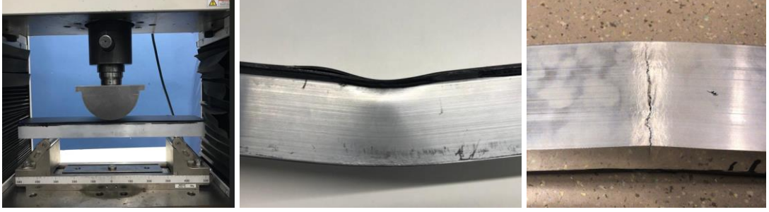
Şekil 3.18 : Kompozitin üstte olduğu hibrit profilin üç nokta eğilme testinden bir görüntü.
