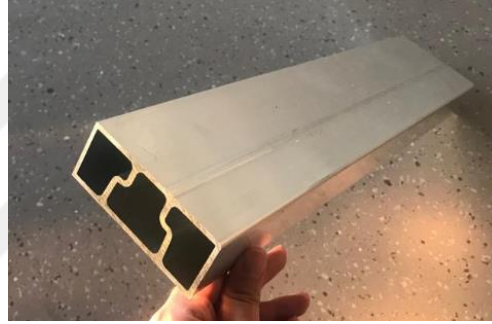
Şekil 2.25 : Üç nokta eğilme testi ve analizi yapılacak profil.
