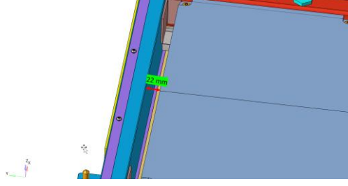
Şekil 2.37 : Batarya taşıyıcı yan duvar ve modüller arasındaki mesafe.
