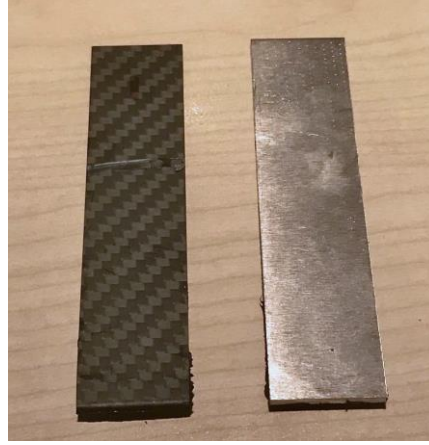
Şekil 2.16 : Yapıştırma karakterizasyonu için üretilen numuneler.
