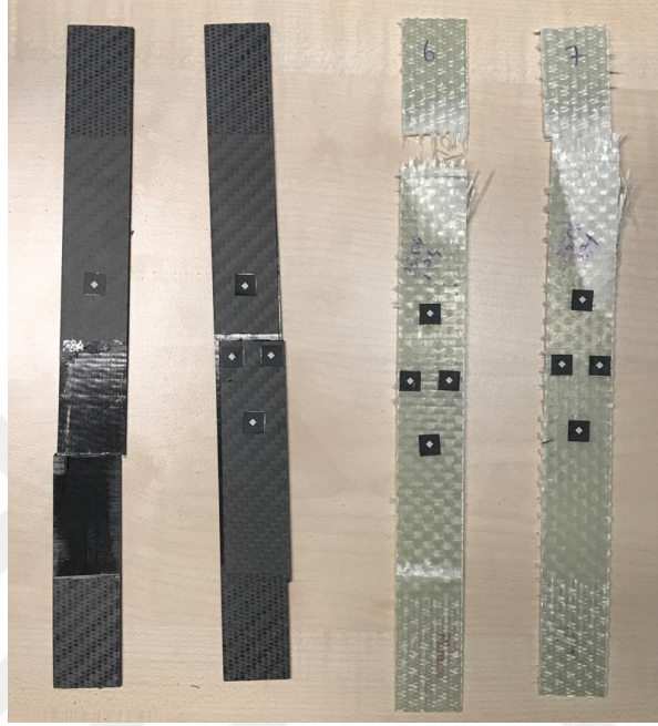
Şekil 3.13 : Karbon fiber ve cam elyaf kompozitlerin 0^\circ ve 90^\circ yönlerinde numuneler çıkarılıp çekme testi sonrasındaki örnek görüntüleri.
