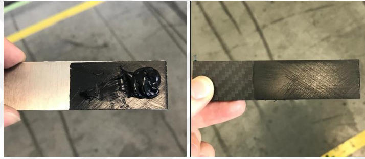
Şekil 2.18 : Yapıştırma karakterizasyonu için üretilen numunelere Sikaflex 268 PowerCure yapıştırıcısı sürülürken ki görüntüsü.
