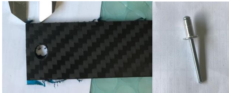
Şekil 2.19 : Perçin ve perçin yuvası açılmış kompozit malzeme.
