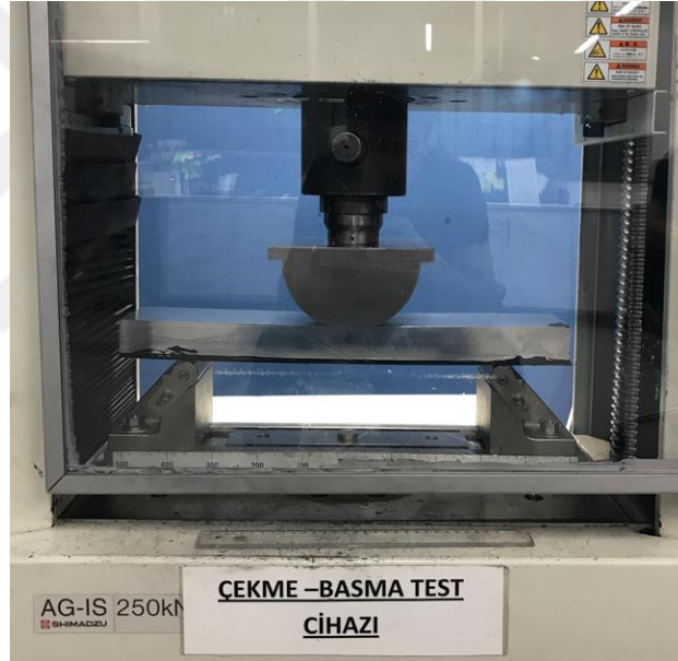
Şekil 2.23: Üç nokta eğme testinden bir görüntü.
