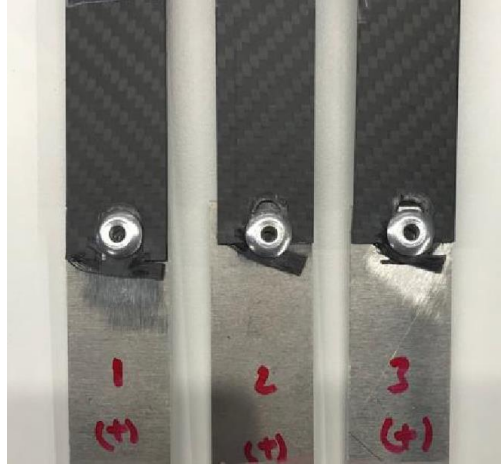
Şekil 3.10 : Perçinle birleştirme uygulanarak karbon fiberin üstte olduğu durumdaki birleştirme alanı kırılma deseni.
