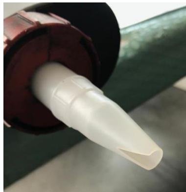
Şekil 2.28 : Üçgen biçiminde kesilmiş yapıştırıcı uç.
