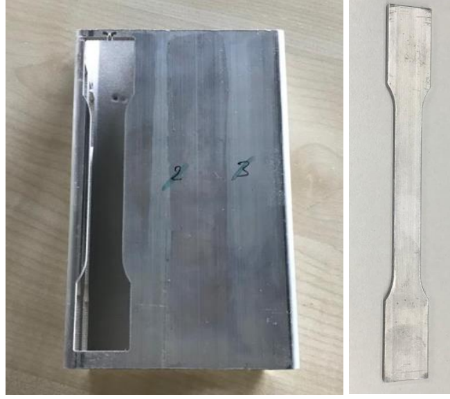
Şekil 2.10 : Profilden çıkarılan çekme çubukları.
