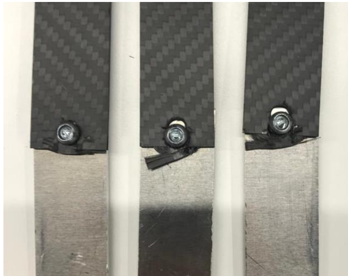
Şekil 3.12 : Perçinle birleştirme uygulanarak karbon fiberin altta olduğu durumdaki birleştirme alanı kırılma deseni.
