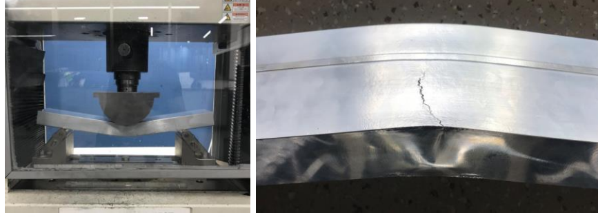
Şekil 3.20 : Negatif yönde üç nokta eğilme testinden bir görüntü.
