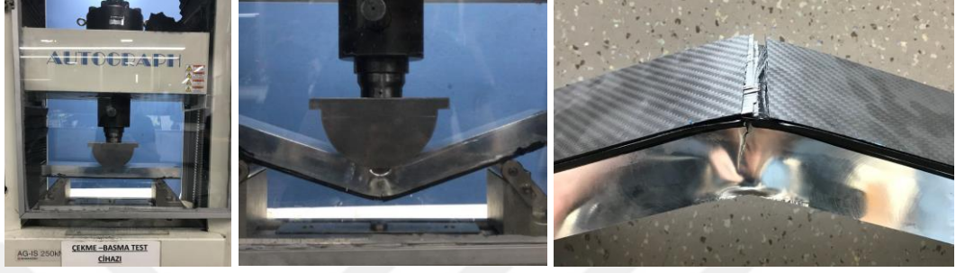
Şekil 3.22 : Kompozitin altta olduğu hibrit profilin üç nokta eğilme testinden bir görüntü.
