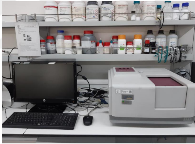
Şekil 2.14 : Karakterizasyon çalışmalarında kullanılan UV-Vis cihazı.
