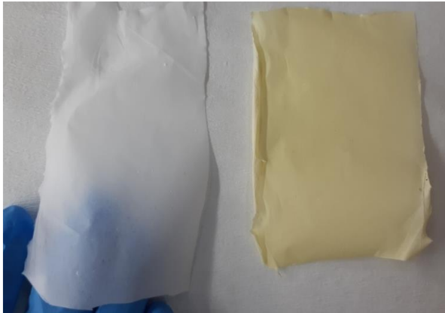
Şekil 2.6 : Saf PCL nanolif ve Pro-2 yöntemi ile üretilen PCL-sFA nanolif.
