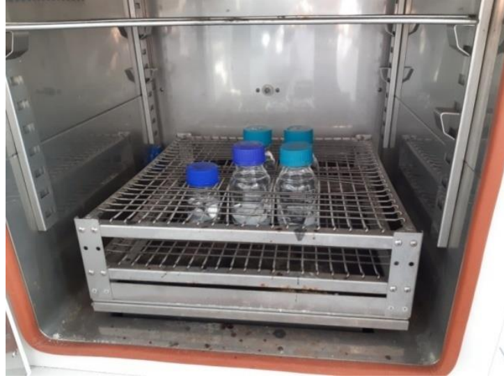
Şekil 2.17 : Çalkalamalı inkübatörde gerçekleşen salım prosesi.
