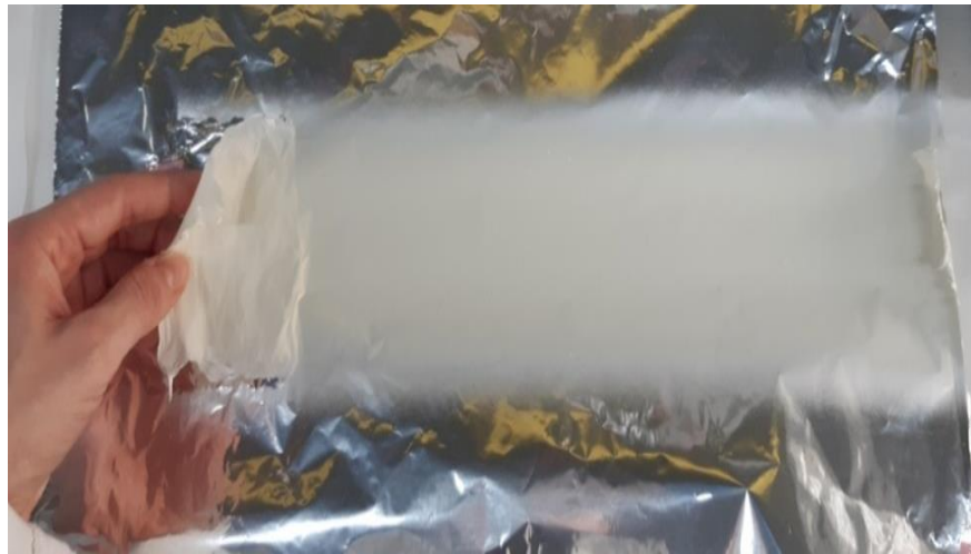
Şekil 2.4 : Pro-1 yöntemine göre üretilen PVA-FA nanolifler.
