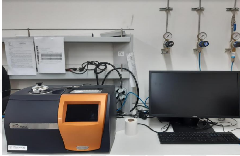
Şekil 2.12 : Karakterizasyon çalışmalarında kullanılan DSC cihazı.
