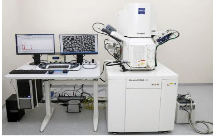
Şekil 2.13 : Karakterizasyon çalışmalarında kullanılan SEM cihazı.
