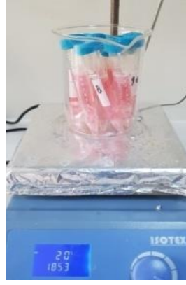
Şekil 2.19 : Nanolif ekstraktlarının hazırlanması.
