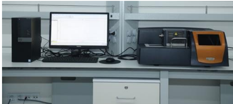
Şekil 2.11 : Karakterizasyon çalışmalarında kullanılan TGA cihazı.
