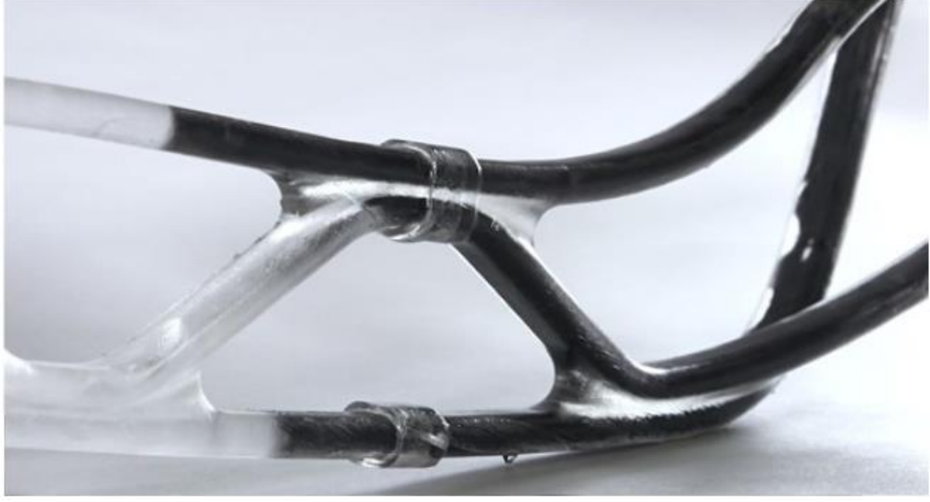
Şekil 1.21 : 3D baskı ile üretilen parçaların sürekli karbon fiberlerle güçlendirilmesi.
