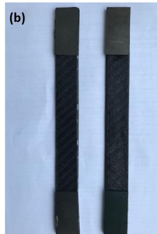
Şekil 4.7 : Çekme testi için çentikli (a) ve metalli (b) numune hazırlama çalışmaları
