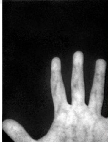
Şekil 4.41: Tasarlanan cihazdan alınan örnek parmak damarı görüntüsü.
