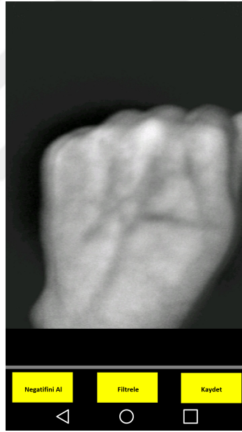
Şekil 4.39: Tasarlanan cihazda görüntü işleme imkan veren Android arayüzü.
