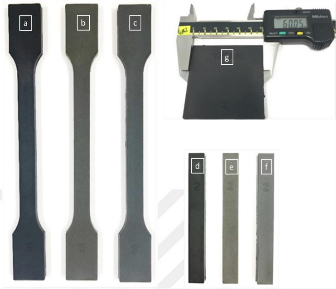
Şekil 2.14 : Üretilen kompozit test plakalarının görüntüleri a) 30KE-PBT, b) 30NiKE-PBT, c) 30TiO 2 NiKE-PBT'ye ait çekme dayanımı test çubukları, d) 30KE-PBT, e) 30NiKE-PBT, f) 30TiO 2 NiKE-PBT'ye ait darbe dayanımı test çubukları, g) 30KE-PBT'ye ait 60x60 cm'lik plaka.
