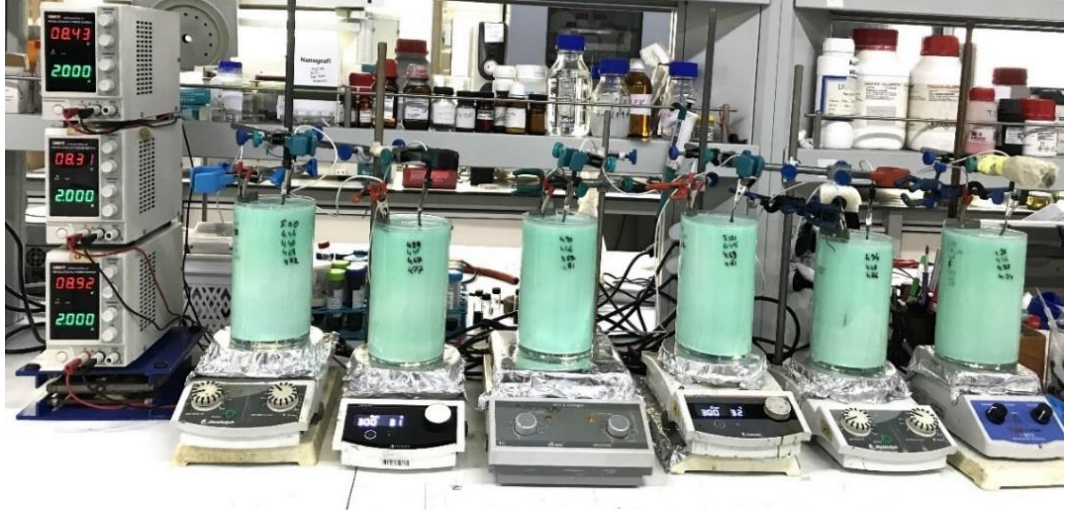
Şekil 2.9 : Elektrodepozisyon ile TiO 2 - Nikel kaplama sistemi.
