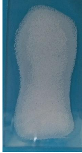
Şekil 3.2: Cam altlık üzerinde toplanmış ve film oluşumu için kurutulmaya bırakılmış mikrobaloncuklar.
