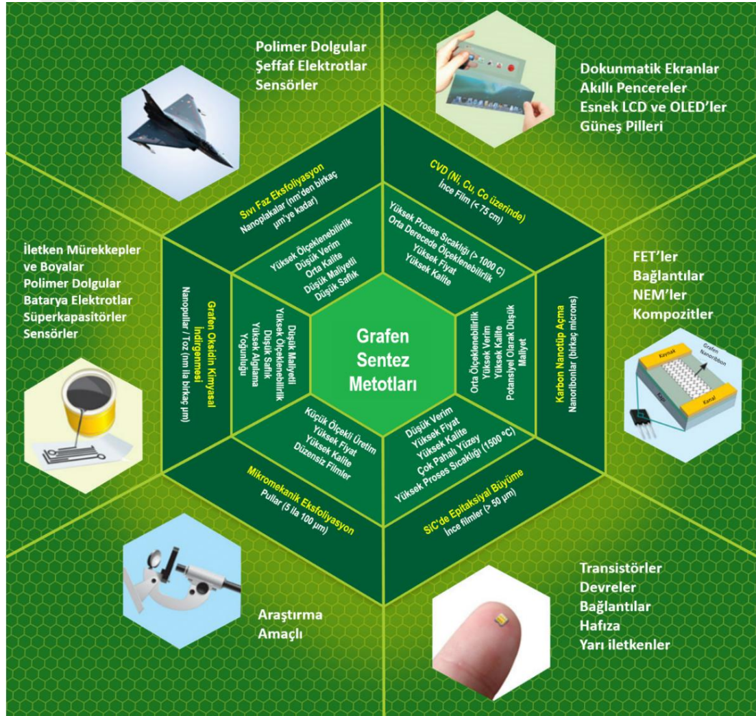
Şekil 1.13 : Grafen sentezinde yaygın olarak kullanılan klasik yöntemleri ve anahtar özellikleriyle birlikte mevcut ve gelecekteki uygulamalarının bir arada şematik gösterimi. Ref. [95]'den uyarlanmıştır.
