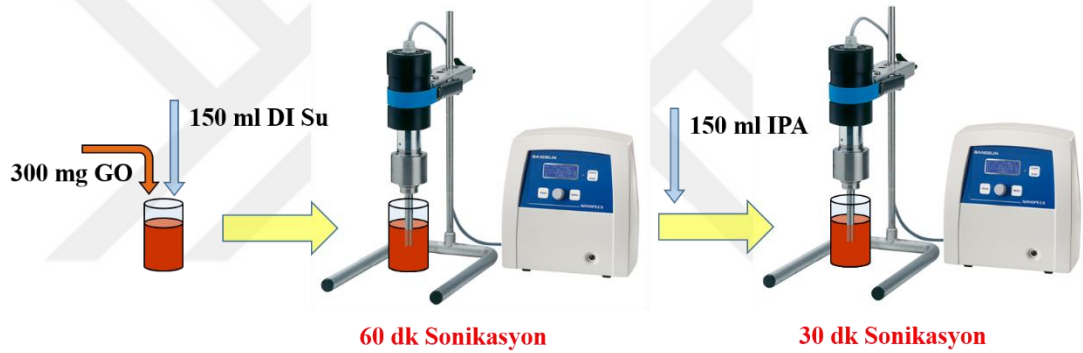
Şekil 6.1 : GO dispersiyonunun hazırlanma prosesi.
