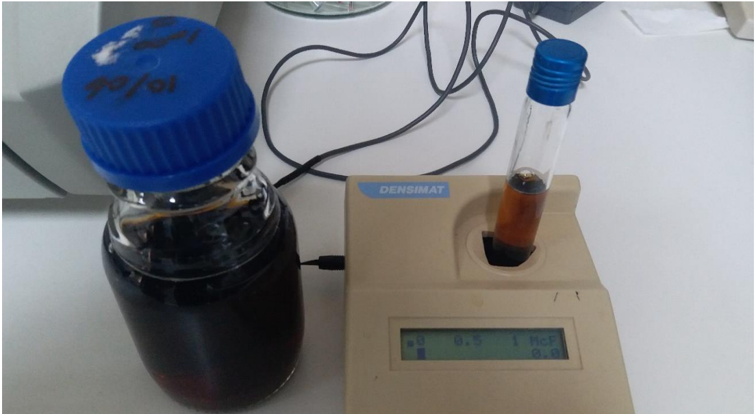
Şekil 2.9 : McFarland ölçümü (MFC)
