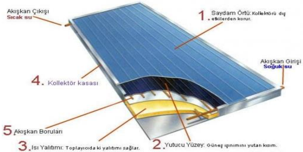
Şekil 1.16 : Düzlemsel kolektör örneği (Url-7).
