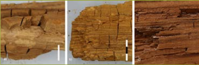
Şekil 5 Esmer çürüklüğün makroskopik görünüşü (Ölçek: a, b 3 cm)
