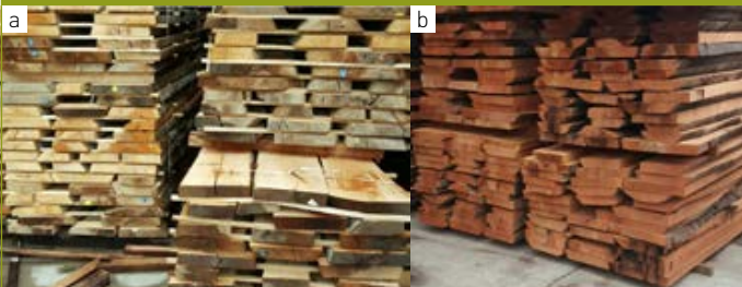
Şekil 38 Kayında Buharlama Öncesi (a) ve Sonrası (b) Renk Değişimi
