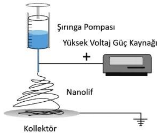
Şekil 2.1 : Elektro eğirme yönteminin şematik gösterimi.
