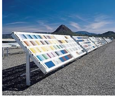
Şekil 1.14 : Atlas Ametek firmasının 45° açıyla yerleştirilmiş arkası açık raflarda doğal yaşlandırma düzeneği [35].
