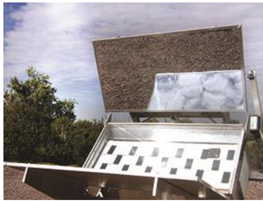
Şekil 1.19 : Q-Lab firmasının otomotiv iç malzemeleri için geliştirdiği AIM Box hızlandırılmış doğal yaşlandırma düzeneği [37].
