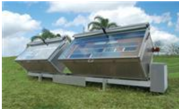
Şekil 1.17 : Q-Lab firmasının otomotiv iç malzemeleri için geliştirdiği AIM Box doğal yaşlandırma düzeneği [37].
