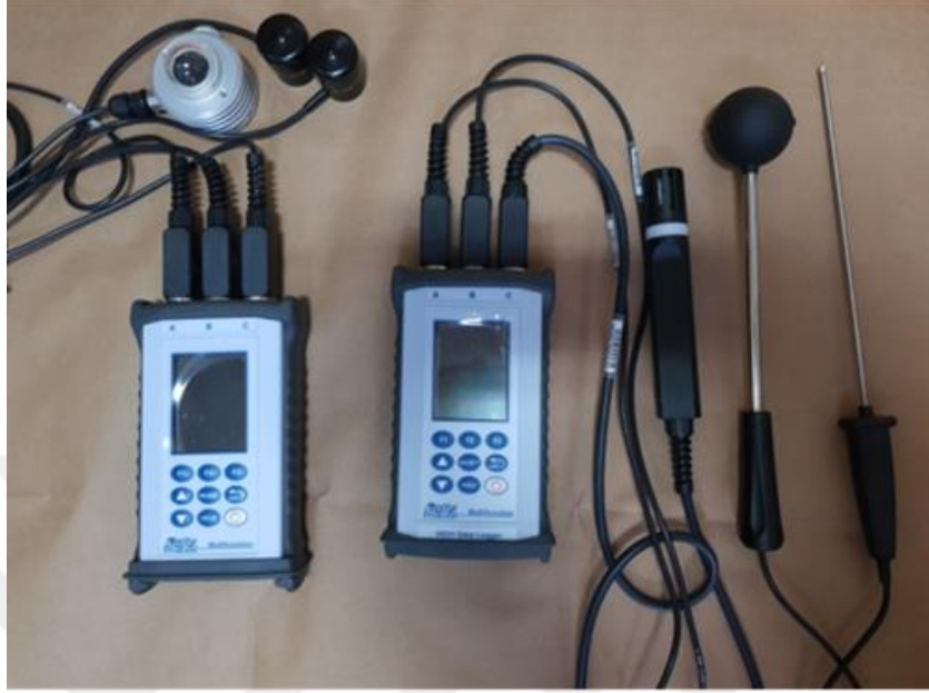
Şekil 2.5 : Delta Ohm HD31 Multifonksiyonel kayıt cihazları ve bu cihazlara bağlı ölçüm problemleri (Soldaki cihaza bağlı problemler; UVA Radyometrik Prob - Delta Ohm LP471UVA, UVB Radyometrik Prob - Delta Ohm LP471UVB , Pyranometre Global Radyasyon Ölçüm Probu - Delta Ohm LPPYRA 03.5 ve sağdaki cihaza bağlı problemler; PT 100 Probu - Delta Ohm TP474C.0, Sıcaklık+Bağıl Nem Probu - Delta Ohm HP472ACR, Küre Sıcaklığı Probu Delta Ohm TP876.I).
