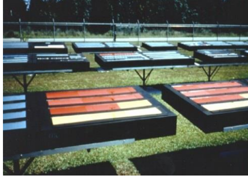
Şekil 1.15 : Atlas Ametek firmasının Miami, Florida'da 5° eğimle cam altında yerleştirilmiş siyah kutu doğal yaşlandırma düzeneği [36].
