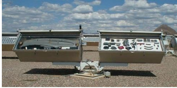
Şekil 1.16 : Atlas Ametek firmasının otomotiv iç malzemeleri için geliştirdiği IP/DP Box doğal yaşlandırma düzeneği [36].
