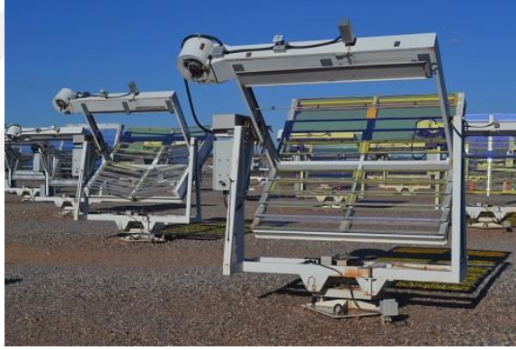
Şekil 1.18 : Atlas Ametek firmasının Phoenix, Arizona'daki EMMAQUA hızlandırılmış doğal yaşlandırma düzeneği [36].
