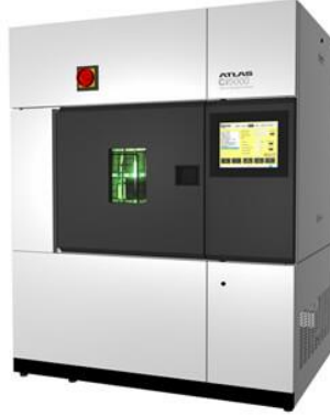
Şekil 1.23 : Atlas firmasının Ci5000 Weather-Ometer model ksenon ark lambalı hızlandırılmış yapay yaşlandırma cihazı [43].
