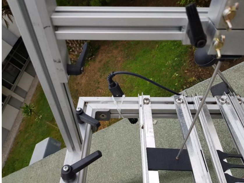
Şekil 2.7 : Yüzey sıcaklığı probunun yerleşimi için özel tasarım prob tutucu.
