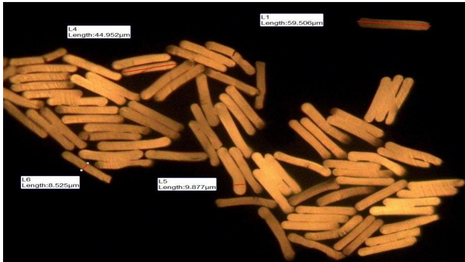
Şekil 3.13 : FY-L-F1 ipliği optik mikroskop görüntüsü.
