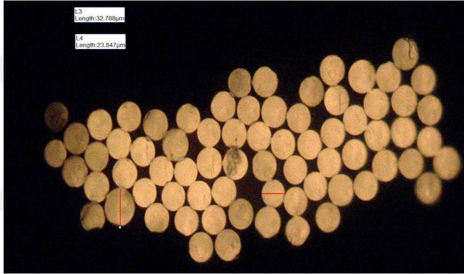
Şekil 3.9 : FY-L-Ro ipliği optik mikroskop görüntüsü.
