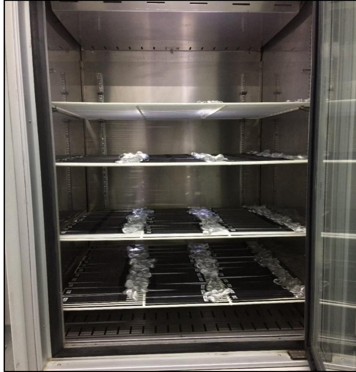
Şekil 2.15 : İplik ve çile numunelerinin bozunma testi için cihaza yerleştirilmesi.
