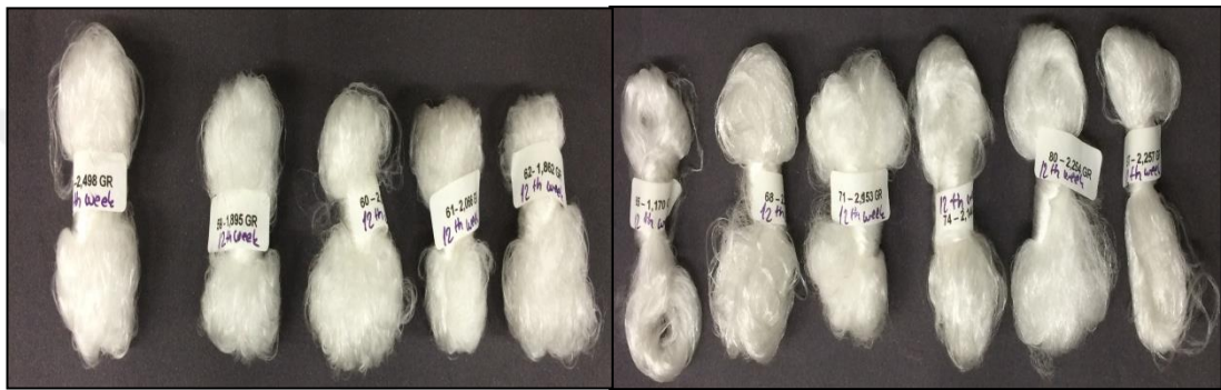
Şekil 3.37 : 12. hafta PLA karışım ve öze kesitli ipliklerin çile görünümleri.
