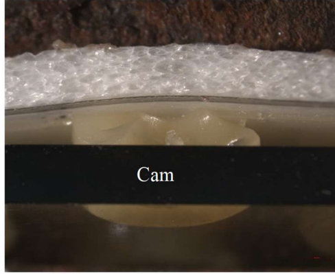
Şekil 3.24 : DP yapının ön yük altında cam yüzey üzerinde açılmasını gösteren şematik çizim ve bu yapının açılma anındaki kesitinin stereo mikroskop görüntüsü.
