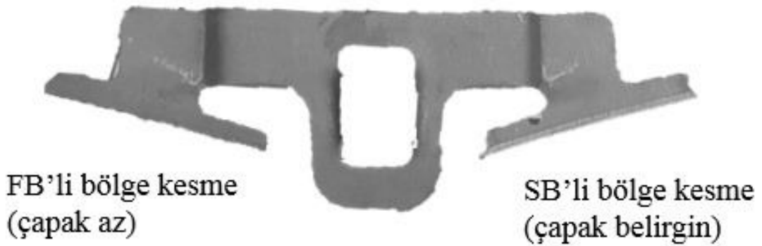
Şekil 5.5 : Araç gerçek gövde güvenlik bileşeninde SB ve FB bölgelerin PSP sonrasında kesme örnekleri.
