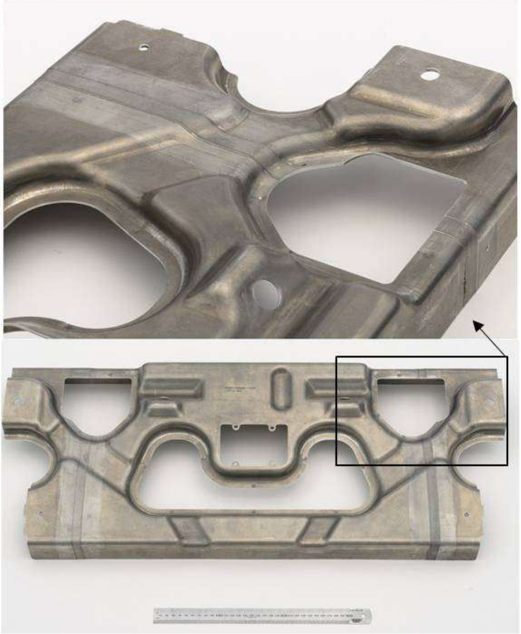
Şekil 1.40 : 5xxx Al Otomotiv parçasına uygulanan SKK işlemi örneği [135].
