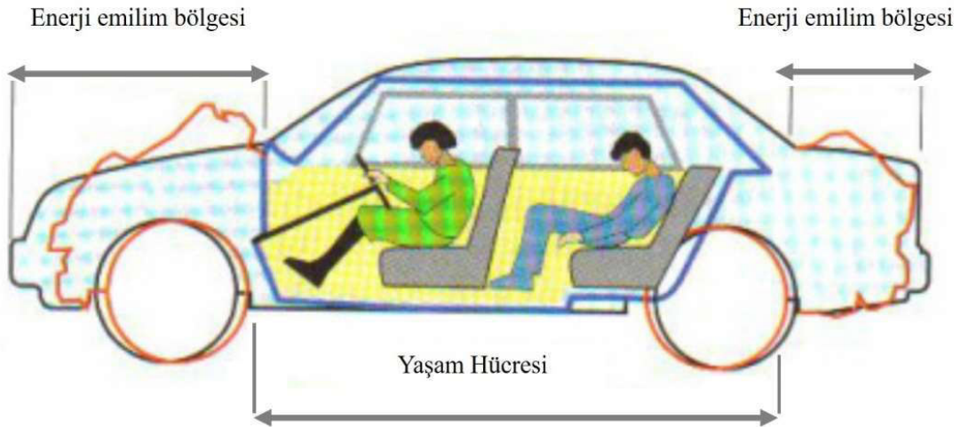
Şekil 1.15 : Araçta yaşam hücresi ve enerji emilim bölgeleri.
