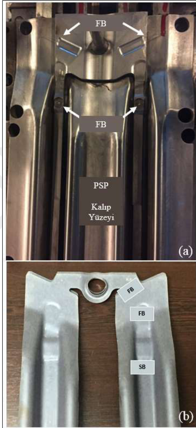
Şekil 5.3 : PSP işlemlerinde SB ve FB bölgeler a) kalıp yüzeyinde b) araç gövde güvenlik bileşeni üzerinde gösterimi.
