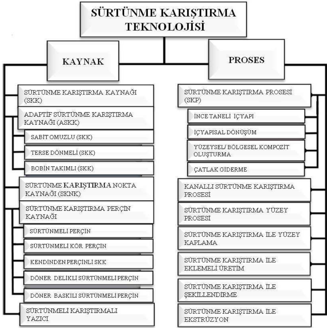
Şekil 1.24 : Sürtünme karıştırma teknolojisi temelinde geliştirilen güncel yöntemler [51].
