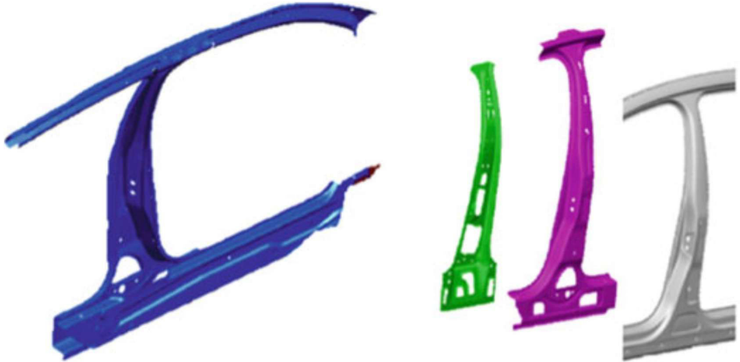
Şekil 1.5 : Doğrudan PSP ile üretilen otomobil bileşenleri.
