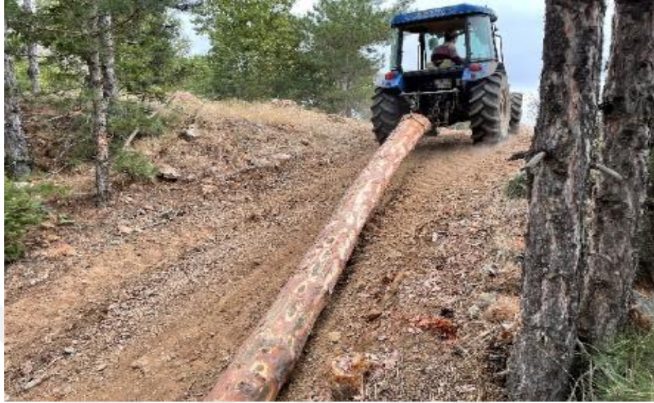
Şekil 1.8 : Tarım traktörü ile sürütme (Büyükorhan, Bursa).
