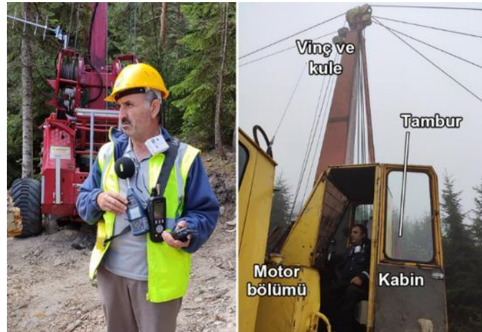
Şekil 5.2 : MOZ500 (sol) ve URUS MIII (sağ)'de operatör konumları
