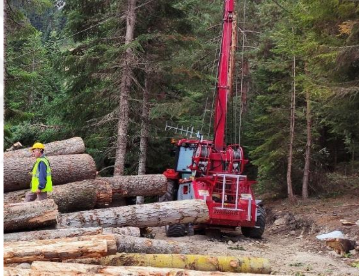
Şekil 1.10 : Traktöre entegre Tajfun MOZ 500 GR hava hattı (Artvin).
