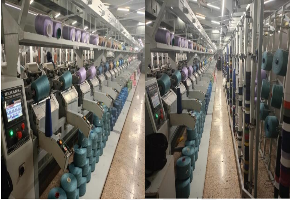
Şekil 2.10 : Hemaks katlama makinesi.
