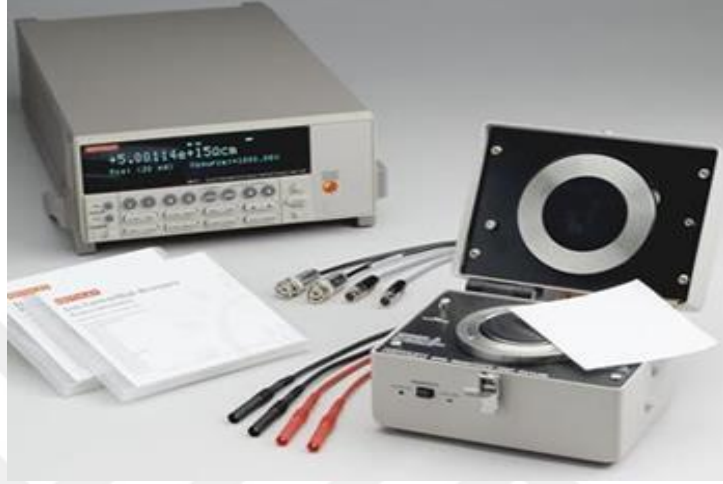
Şekil 2.18 : Statik elektriklenme direncinin ölçüldüğü cihaz.
