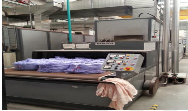
Şekil 2.5 : Akrilik elyaf bamsı için RF kurutma makinesi.
