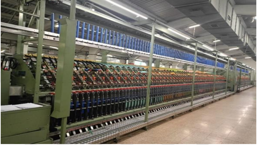
Şekil 2.8 : Ring iplik makinesi (Yarıkamgarn hattı).
