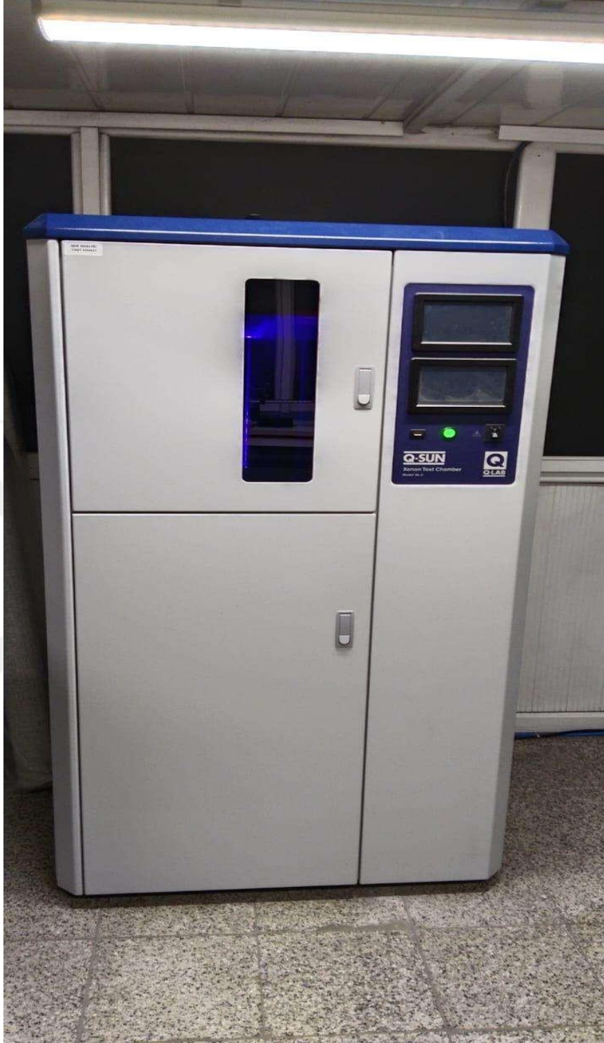
Şekil 2.7 : Hava şartlarına karşı renk haslıđı test cihazı
