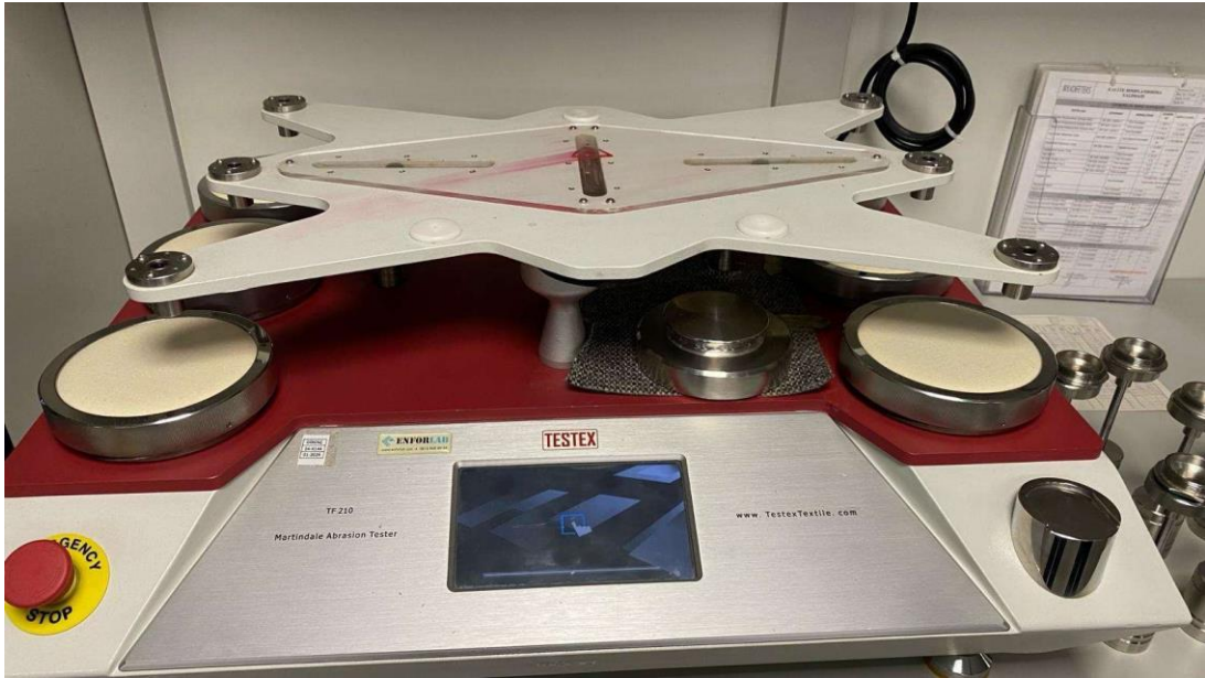
Şekil 2.5 : Martindale aşınma test cihazı
