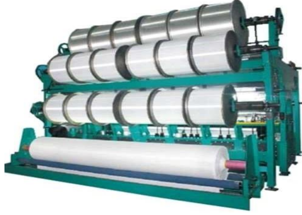
Şekil 1.4 : Çözümlü örme makinesindeki iplik bobinleri (leventleri)
