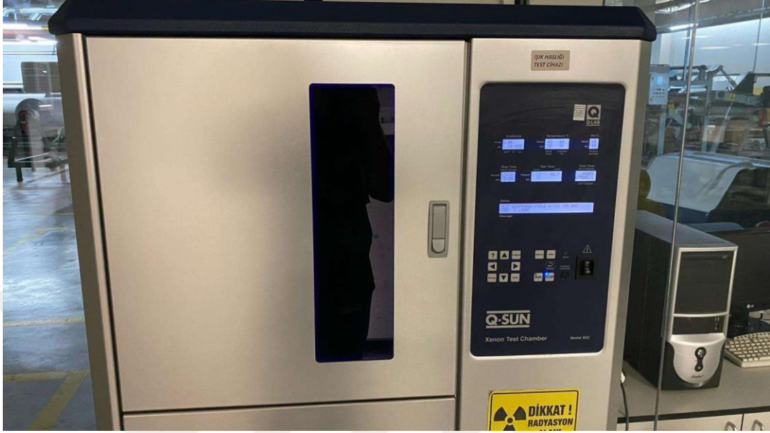
Şekil 2.6 : Işığa karşı renk haslığı test cihazı
