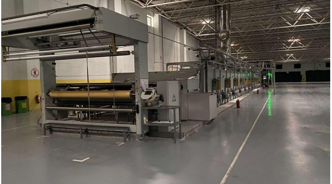
Şekil 2.9 : Monforts 10 kamaralı ram makinesi
