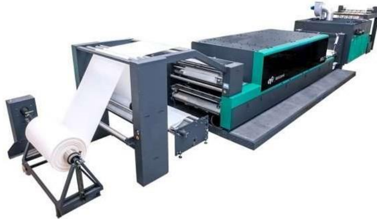
Şekil 1.6 : Efi Reggiani Bolt tek geçiş dijital baskı makinesi (Url-5)
