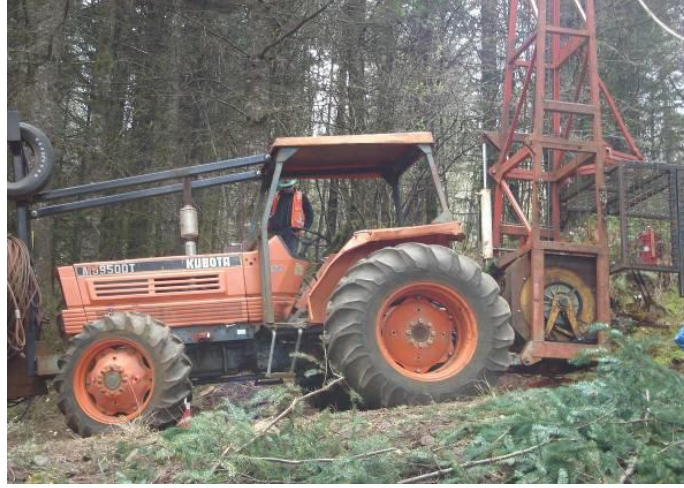
Şekil 1.5 : Tarım traktörüne entegre edilmiş Koller K300 hava hattı (Foto: T.Öztürk).
