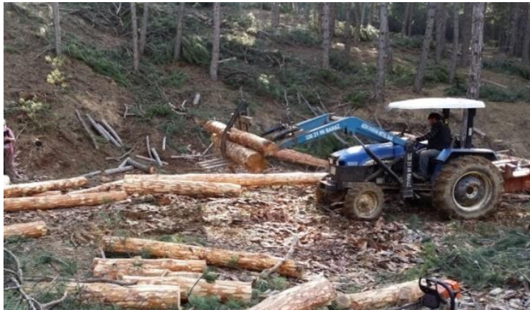
Şekil 1.22 : Yükleme kısıkaçları ile entegre edilen tarım traktörü.
