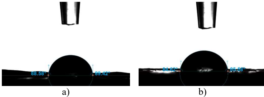
Şekil 3.73 : a) PLA/PP (30:70), b) PLA/PP (30:70)+%1,5 KKA+%1 UA karışımlarının temas açısı ölçüm görüntüleri.
