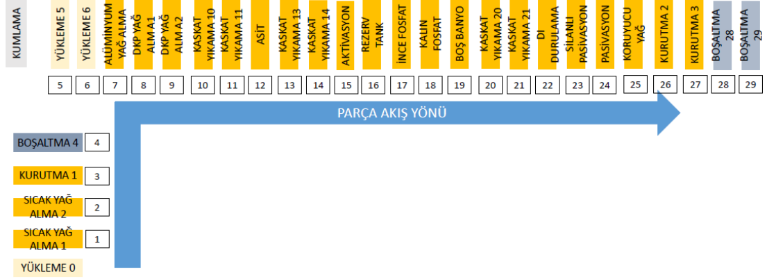
Şekil 3.13 Fosfat hattı parça akış yönü.
